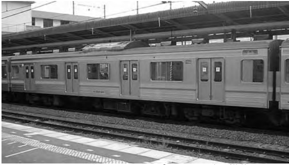
モハ 204 形：MG、コンプレッサなどを搭載
