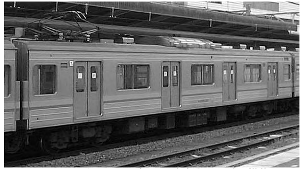
モハ 205 形：パンタグラフ、主制御器などを搭載
